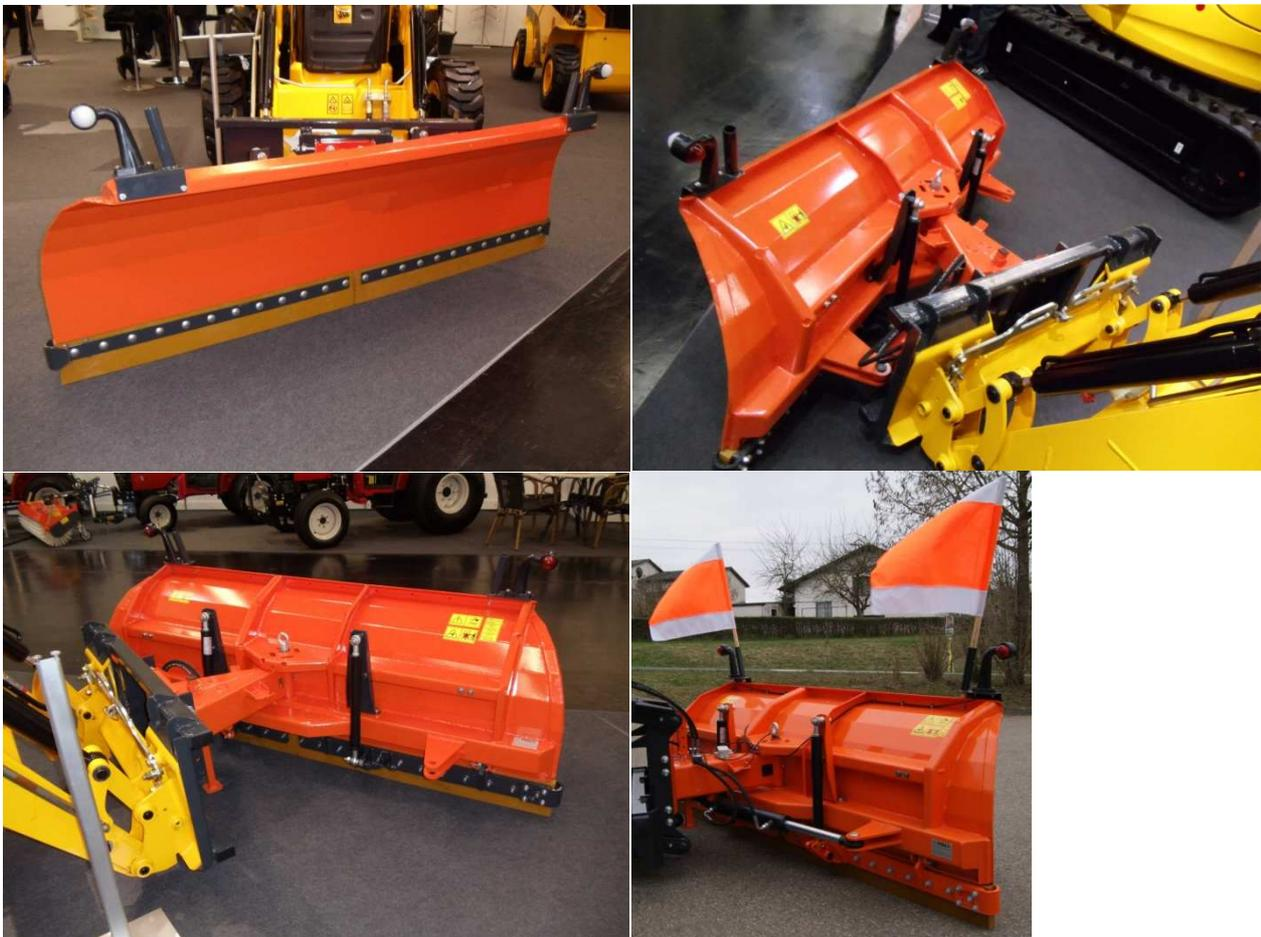
Serienmäßig Seitenverstellung bis 30° manuell, Räum leisten Vulkollan, 2 Federklappen über Gasdruckfedern – Druck verstellbar! Stabile verwindungsfreie Ausführung, schwebende Aufhängung, Pendelausgleich, Warnfahnen, Material ST50, Lackierung reinorange RAL 2004.
